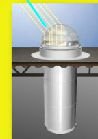
光导管 Solar tube
